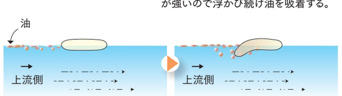
上流側先端は沈むが浮力と油吸着力が強いので浮かび続け油を吸着する。
