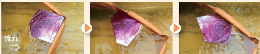
●多量(600cc)の着色軽油を吸収させたパフィンオイルマット。30分後も浮いています。
